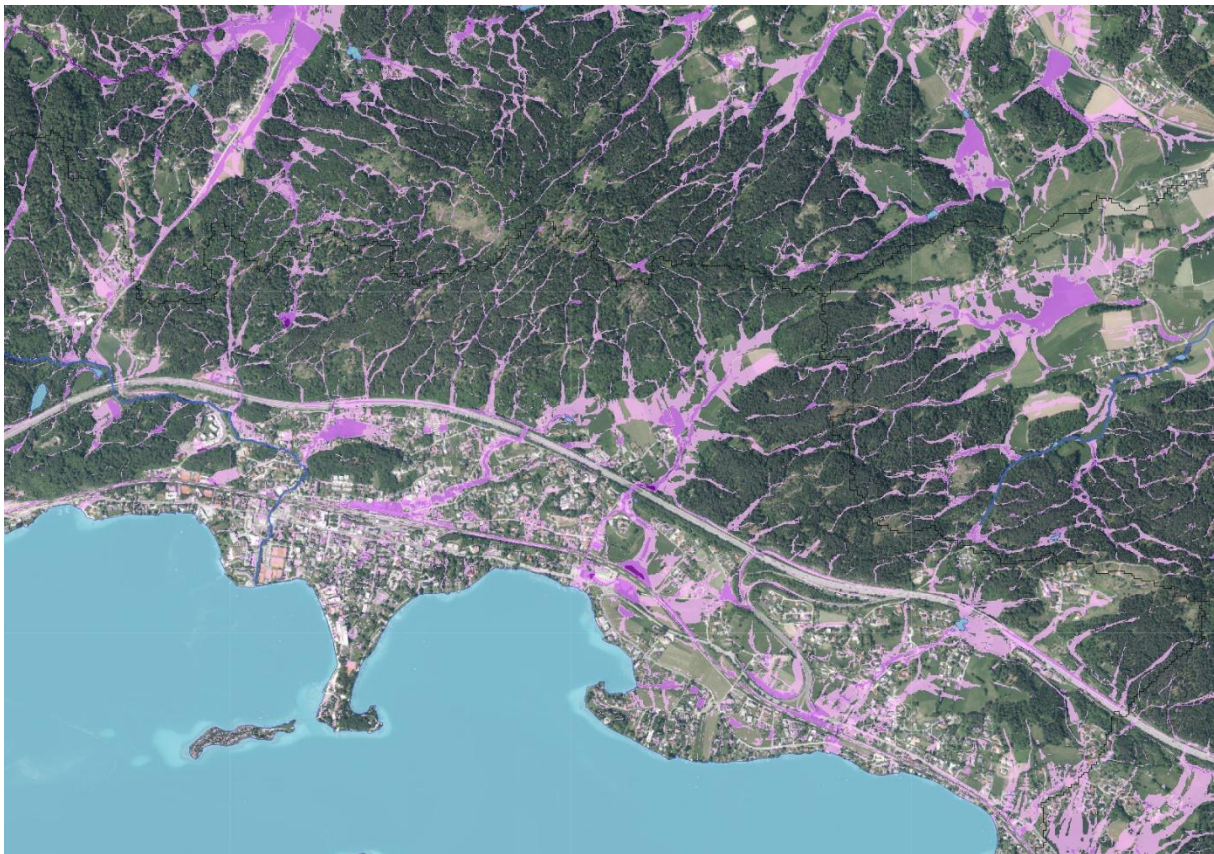
Abb. 7: Oberflächenabfluss in der Gemeinde Pörtschach am Wörther See.
